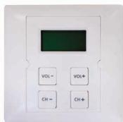
**Controlador de canal y volumen.** Selección de hasta 99 canales programables y control de volumen (0-9). Instalado en la zona local y conectado al sistema por bus, provee a la zona de selección de fuente, control de volumen. Bus: RS-485 con una distancia máxima de conexión de 1.200 metros. Conector de 4 polos (terminal block). Selector de canal DIP. Función de autobloqueo. Display LCD de 2x8 caracteres. Dimensiones: 86 x 56 x 40 mm. Material ABS. Color blanco.
