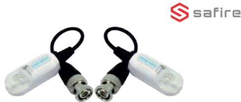
Balun de 1 canal pasivo Optimizado para tecnologías HD Transmisión de vídeo, BNC/UTP 2 pines Alcance HDTVI 250/250m (720p/1080p) Alcance HDCVI 400/250m (720p/1080p) Alcance AHD 350/200m (720p/1080p) Conexión rápida
