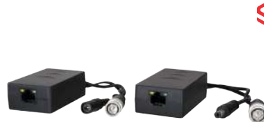
Balun de 1 canal pasivo, emisor y receptor Optimizado para tecnologías HD Transmisión de vídeo, datos y alimentación Conexión BNC /Par Datos/Jack/RJ45 Emisor y receptor Alcance HDTVI 200/200m, HDCVI 400/200m, AHD 300/200m (720p/1080p)
