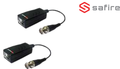
Balun de 1 canal pasivo Optimizado para tecnologías HD Transmisión de vídeo (emisor y receptor) Alcance HDTVI 210/230m (720p/1080p) Alcance HDCVI 440/220m (720p/1080p) Alcance AHD 320/330m (720p/1080p) Evita bucles de tierra e interferencias
