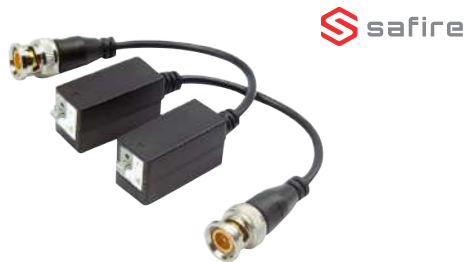
Balun de 1 canal pasivo Optimizado para tecnologías HD Transmisión de vídeo Conexión BNC/UTP 2 pines Alcance HDTVI 250/250m (720p/1080p) Alcance HDCVI 400/250m (720p/1080p) Alcance AHD 350/200m (720p/1080p)
