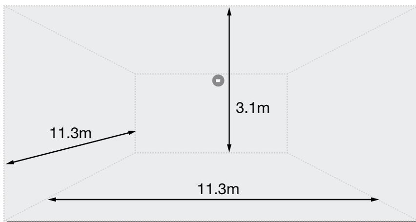
C-3-15 en que C significa que se instala en el techo y tiene la siguiente cobertura
